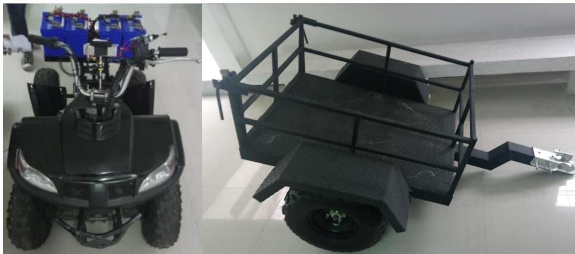
ภาพที่ 1 รถพลังงานไฟฟ้าสำหรับใช้ขนส่งผลิตผลทางการเกษตร ที่ดัดแปลงจากโครงสร้างเก่าของรถเอทีวี
