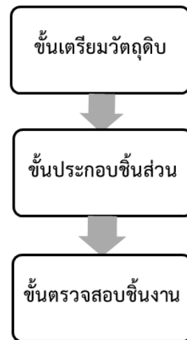
ภาพที่ 1 กระบวนการประกอบเพลลาเกี่ยวสายเบรก
