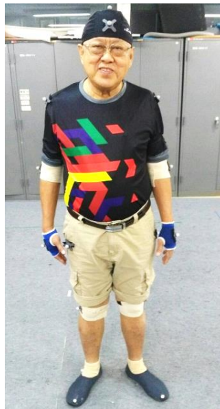
ภาพที่ 4 แสดงตัวอย่างการติด Marker เพื่อใช้งานอุปกรณ์ Motion Capture
