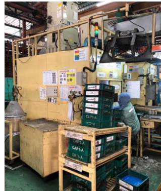
ภาพที่ 5 จัดวางชิ้นส่วนวัสดุให้ตรงกับตัวจับยึดชิ้นงาน
