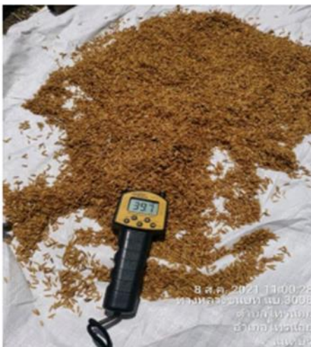
ภาพที่ 11 การวัดค่าความชื้นและจดบันทึกผลการทดสอบ
