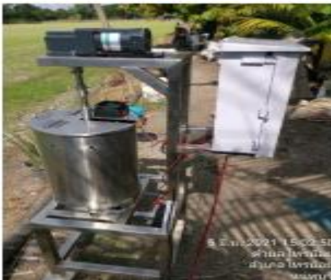
ภาพที่ 14 นำข้าวเปลือกใส่ลงในเครื่องอบแห้งข้าวโดยใช้ทั้งมอเตอร์ใบกวนและฮีตเตอร์
